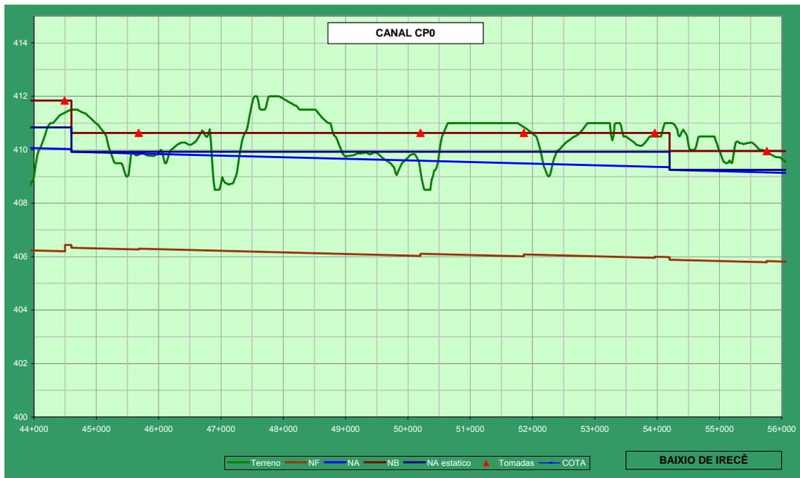
Figura 5.4: Perfil Longitudinal do Canal Principal CP0
